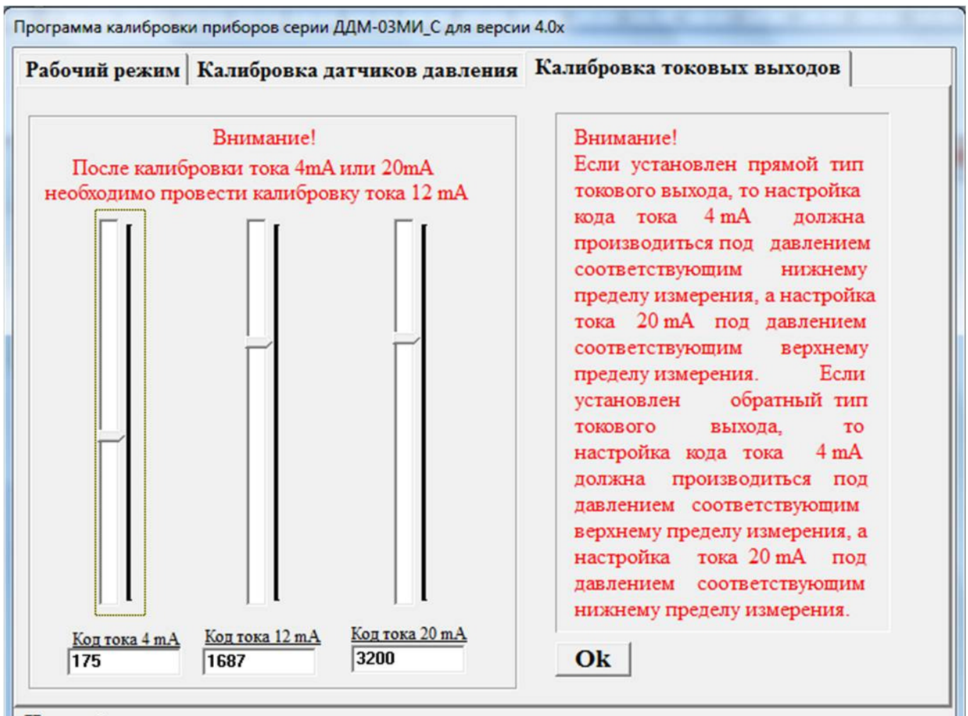
Рис. 4. Вкладка «Калибровка токовых выходов».
