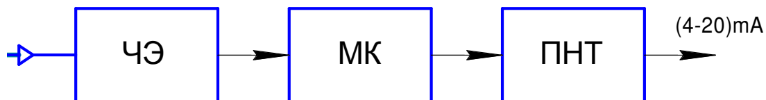
Рис.1 Структурная схема датчика.
